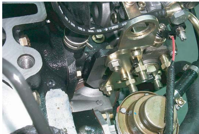
Bomba inyectora desconectada
